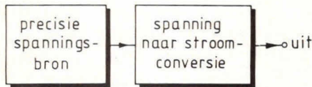
Fig. 1. Om een stroom-ijkbron te krijgen, is het gemakkelijk om eerst een precisiespanningsbron te nemen en van daaruit een conversie te maken naar stroom.
